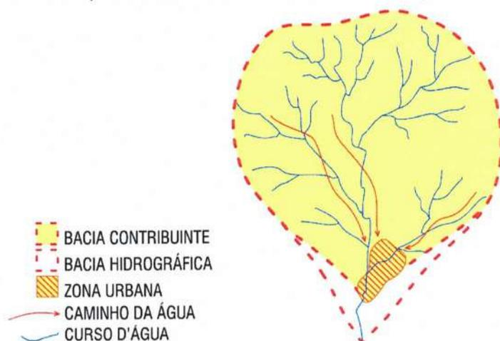
Figura 50: Representação das áreas consideradas para o cálculo da descarga máxima. Desta maneira, foram calculadas as áreas contribuintes bem como a descarga máxima esperada em cada uma das áreas urbanas dos distritos do Município de Rodeiro (Tabela 31).
